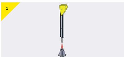
In figura è raffigurato l'ancoraggio del supporto superiore. Se si utilizza un'estensione dell'ancoraggio, installarla per prima. Può essere richiesto l'uso di una scala.
