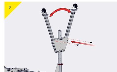
Abra la pata e inserte el pasador de bloqueo de bola en el segundo agujero que asegura la pata en su posición abierta. Repita esto para la segunda pata incluida en el mismo marco en A.
