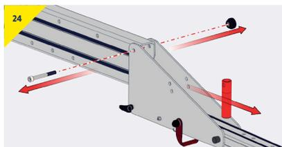
El ajuste del ancho del brazo pescante puede realizarse durante los pasos 4 o 5.
