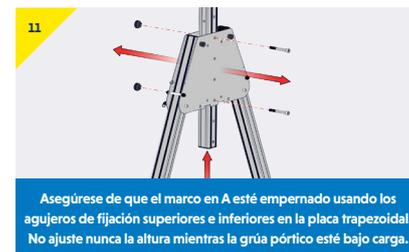
Asegúrese de que el marco en A esté empinado usando los agujeros de fijación superiores e inferiores en la placa trapezoidal. No ajuste nunca la altura mientras la grúa pórtico esté bajo carga.
