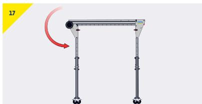
**Si están instalados, asegúrese de que los frenos de rueda se aplican antes de levantar una carga.**
