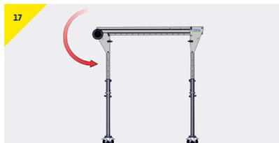
**Falls vorhanden, sicherstellen, dass die Lenkrollenbremsen vor dem Anheben einer Last betätigt werden.**
