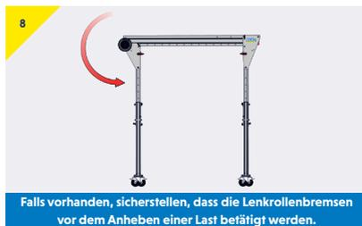
**Falls vorhanden, sicherstellen, dass die Lenkrollenbremsen vor dem Anheben einer Last betätigt werden.**
