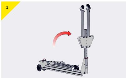
Den oberen A-Rahmen in eine vertikale Position drehen.
