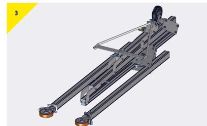
Questa illustrazione mostra una spalla ad A prima del suo assemblaggio.
