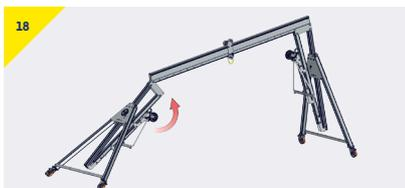
Per maggiore sicurezza, è possibile posizionare temporaneamente un bullone di ricambio nel punto di regolazione.
