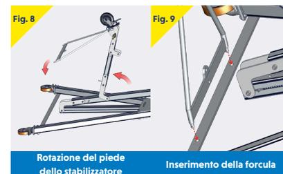
Rotazione del piede dello stabilizzatore
