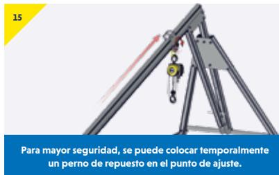
**Para mayor seguridad, se puede colocar temporalmente un perno de repuesto en el punto de ajuste.**
