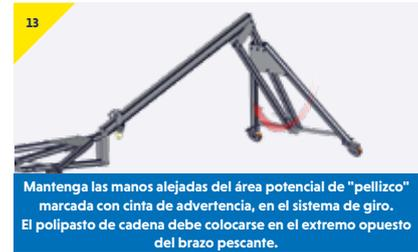
**Mantenga las manos alejadas del área potencial de "pellizco" marcada con cinta de advertencia, en el sistema de giro. El polipasto de cadena debe colocarse en el extremo opuesto del brazo pescante.**
