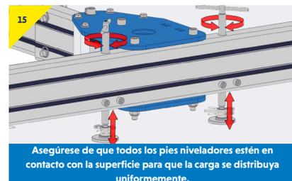
Asegúrese de que todos los pies niveladores estén en contacto con la superficie para que la carga se distribuya uniformemente.
