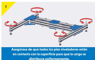
Asegúrese de que todos los pies niveladores estén en contacto con la superficie para que la carga se distribuya uniformemente.
